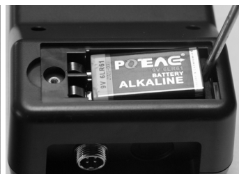
Togliere la pila facendo leva con un cacciavite
