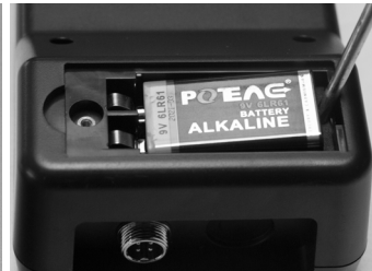
Um die Batterie zu entfernen, hebeln Sie sie mit einem Schraubendreher aus.
