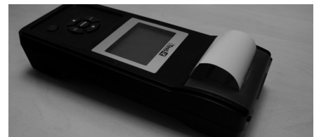
C. Colocar una corta longitud de papel del compartimiento y presionar sobre la tapa transparente para cerrar.
