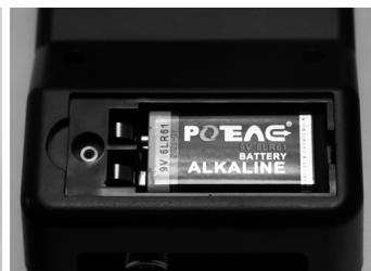
Riposizionare nel vano una nuova pila 9V
