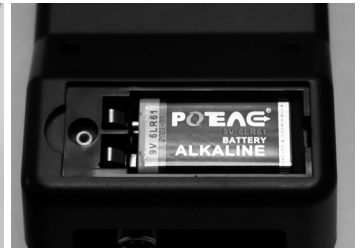
Setzen Sie eine neue 9V-Batterie ein.
