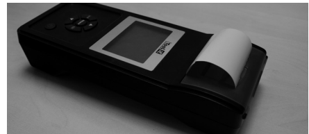
C. Papier ein wenig aus dem Papierfach herausziehen und auf den transparenten Deckel drücken, um ihn zu schließen.
