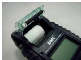
B. Placer un nouveau rouleau de papier dans le compartiment. Référence bobine papier : 056237 ou 056633
