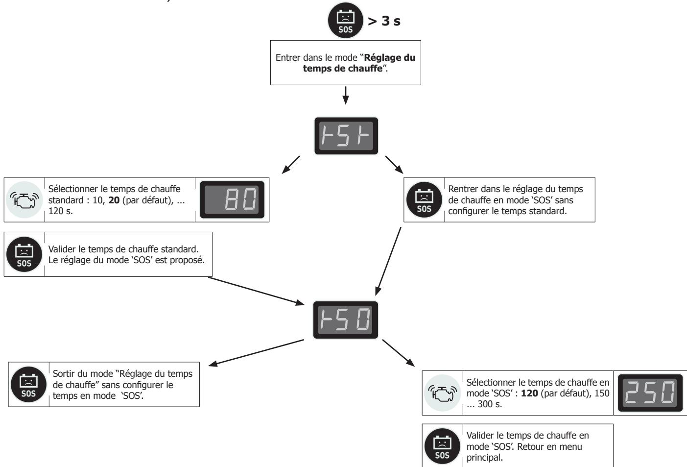
**! En mode SOS, il n'y a plus de protections (sur la tension 12 V / 24 V, en cas d'inversion de polarité...). Le réglage de temps peut endommager la batterie :**
