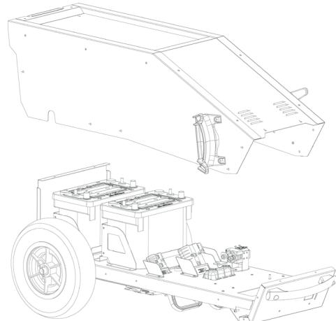
**3** После снятия корпуса отсоедините АКБ. Для отсоединения кабелей воспользуйтесь гаечными ключами 3/8 и 5/16 и моментом затяжки 15 Ньютонов.
